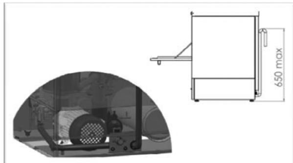
**Accorder une attention particulière à ce que le point le plus élevé du tuyau de vidange se trouve à une hauteur inférieure à 650 mm. Si ce n'est pas le cas, il se produira un retour d'eau.**
