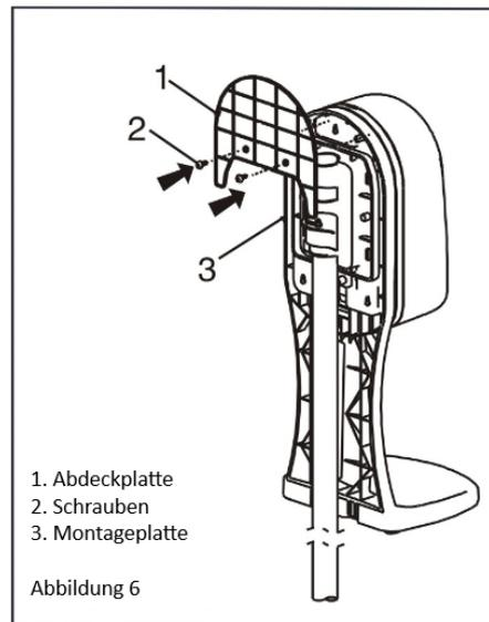
6. Siehe Abbildung 6, befestigen Sie die Abdeckplatte an der Montageplatte mit Schrauben (Zubehör).
