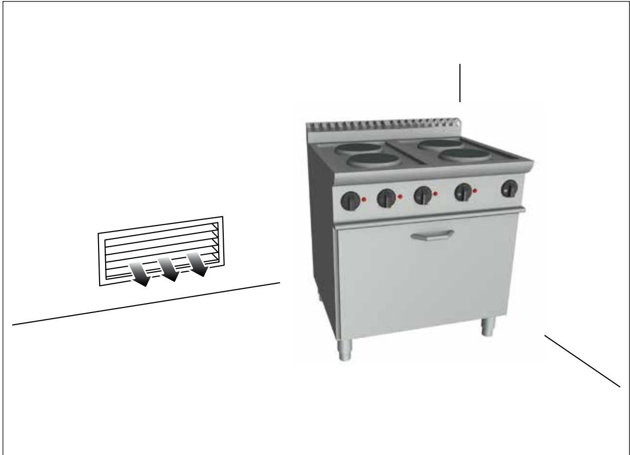
Abb. 21 Belüftung des Installationsraums
