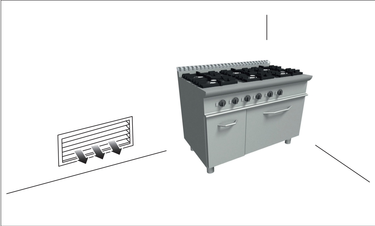
Abb. 25 Belüftung des Installationsraums
