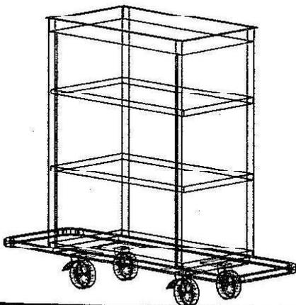
5. Das Oberteil mit Fächern wird mit der Rückwand und den Seitenteilen verschraubt.
